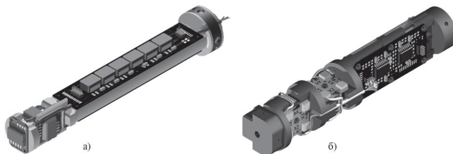
1.7 Сурет - Үш осьті блоктың құрылымы: а) магнитометрлер, б) акселерометрлер
